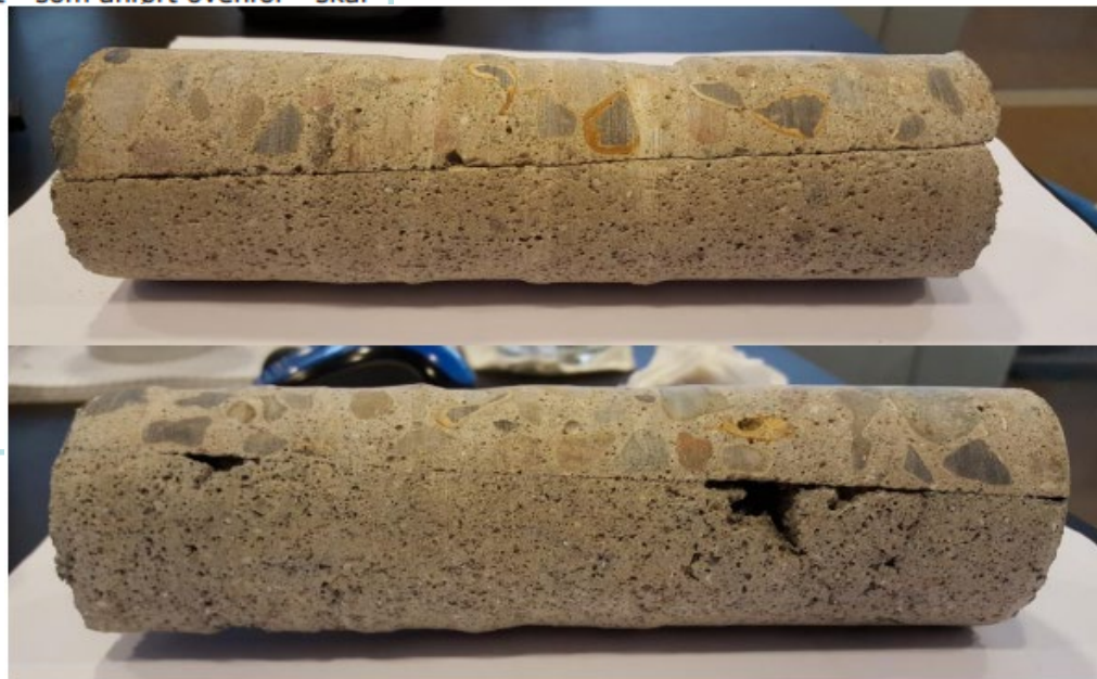
Fig. 6.5: Borekerner udtaget vandret i understøbning udført med mørtelpølse. Den nederste kerne indeholder mindre luftindeslutninger, der dog ligger under acceptkriteriet og kan derfor accepteres.
