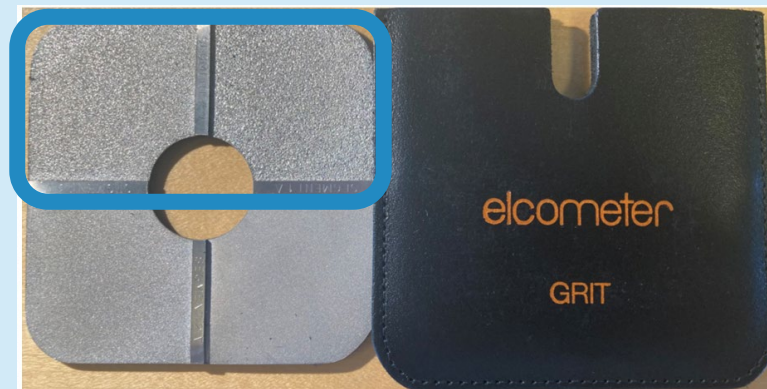
Figur 7-1 Billedet viser en referenceplade iht. ISO 8503-1 /-2 – hér opnået ved blæserensning med skarpkornet blæsemiddel på stål. De to med blåt indrammede felter svarer til det man bør tilstræbe ved rensning af betonoverflader.
